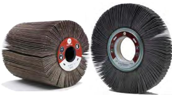
Le ruote lamellari in Trizact™ hanno una durata maggiore rispetto agli abrasivi tradizionali e si possono utilizzare fino al completo esaurimento della superficie abrasiva perché sono realizzate con uno speciale abrasivo a struttura piramidale: i granuli sono piramidi identiche distribuite in modo uniforme. Durante la lavorazione queste piramidi si consumano uniformemente, permettendo di ottenere una finitura costante fino alla completa usura dell'utensile.
